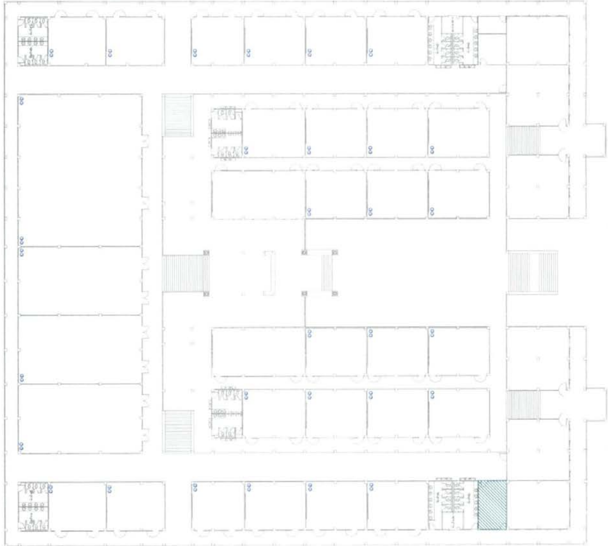
แบบแสดงตำแหน่งจุดติดตั้งสายสัญญาณ UTP CAT6 สำหรับเครื่องคอมพิวเตอร์ สำหรับห้องเรียน
